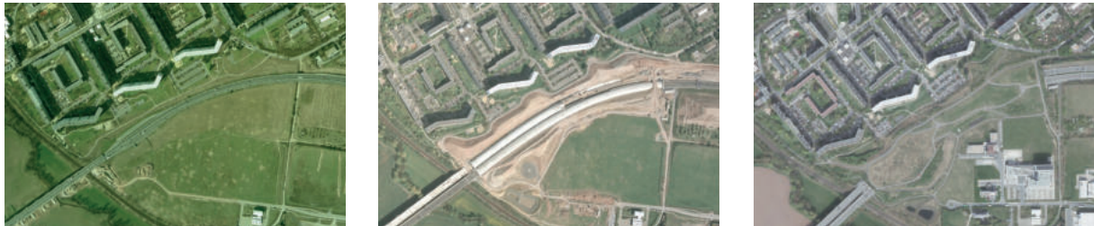
Abb. 19: Zeitreihe zur Einhausung der BAB 4 bei Jena mit Luftbildern von 2004, 2008 und 2024 (v. l. n. r), ©GDI-TH
