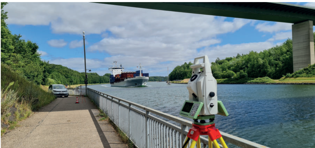
Abb. 2: Die WSV bei Vermessungsarbeiten an der Levensauer Hochbrücke über den Nord-Ostsee-Kanal. Foto: Markus Erfert, Wasserstraßen-Neubauamt Nord-Ostsee-Kanal, 27. Juli 2022
